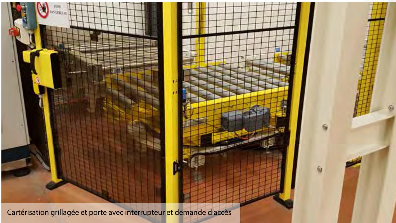
Cartérisation grillagée et porte avec interrupteur et demande d'accès
