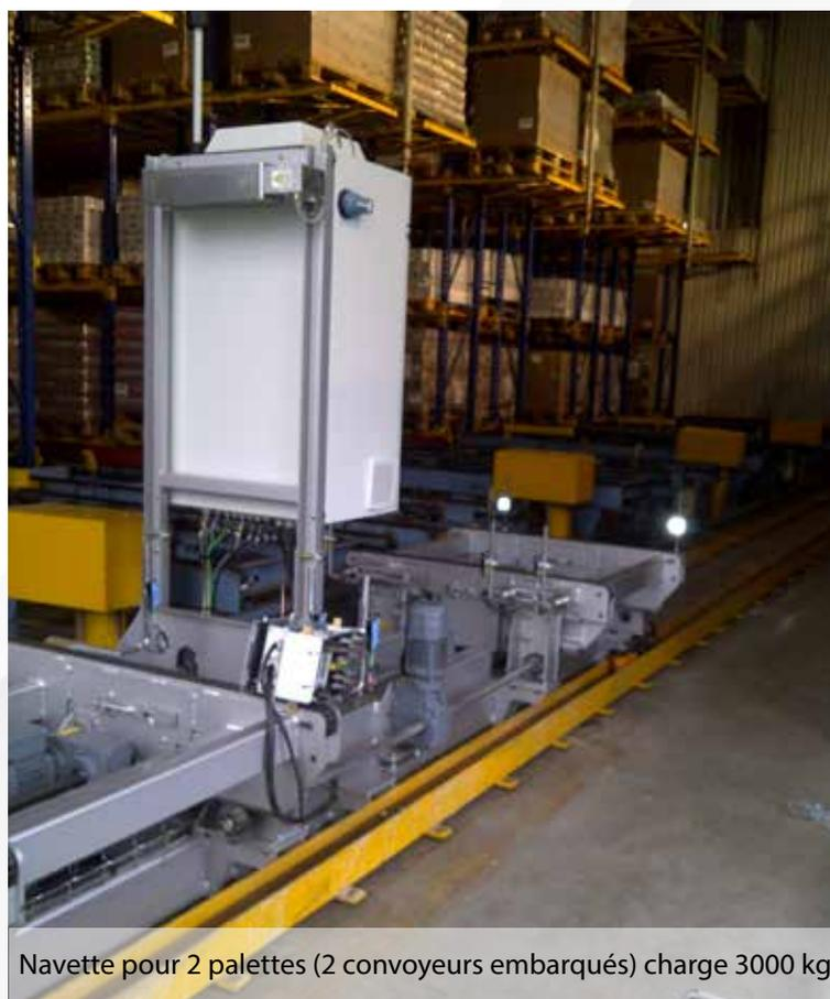
Navette pour 2 palettes (2 convoyeurs embarqués) charge 3000 kg
