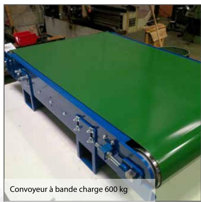
Convoyeur à bande charge 600 kg
