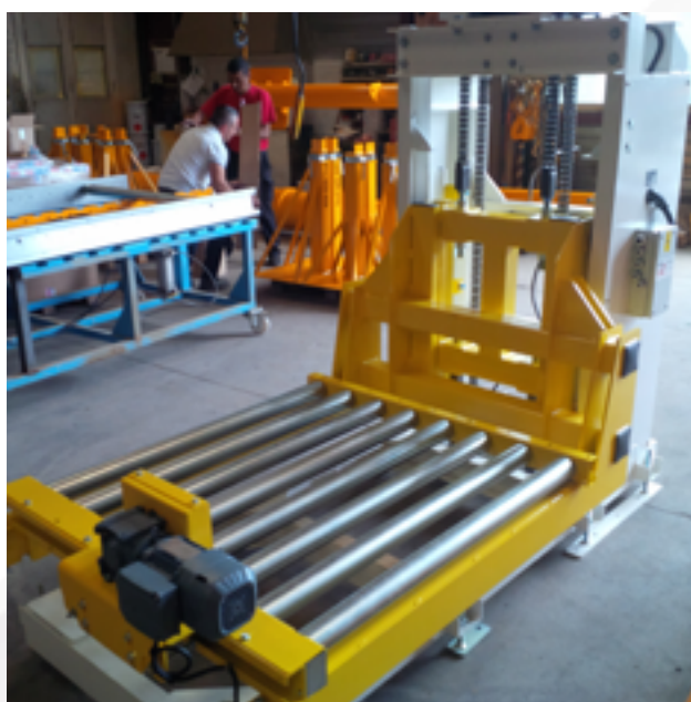
Exemple de convoyage : navette équipée d'un élévateur et convoyeur à benne (niveau 250 mm)
